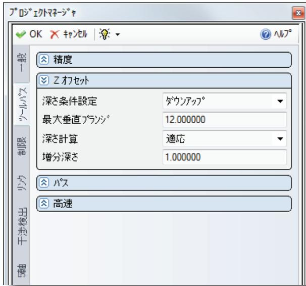
[深さ条件設定] が [ボトムアップ] に設定されているときに、切削パスはユーザー定義の最大深さで始まり、上方へ増加していきます。
